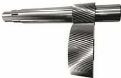
چرخنده هلیکال پمپ سانداپن با دور کاری 28 000RPM
