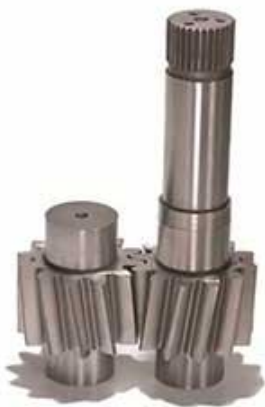
چرخنده هلیکال مربوط به Gear Pump شرکت پتروشیمی خوزستان
